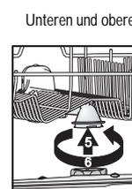
Unteren und oberen Sprüharm einsetzen und gut festziehen.
