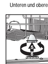
Unteren und oberen Sprüharm einsetzen und gut festziehen.
