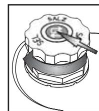
Deckel aufschrauben. Salzreste am Deckel müssen entfernt werden. Einige Salzbehälter verfügen über eine Füllstandanzeige im Deckel (siehe weiter unten die Befüllungsanweisungen).
