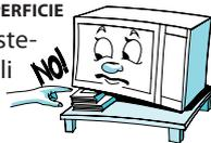
**COLLOCARE IL FORNO LONTANO** da altre sorgenti di calore. Per consentire una ventilazione sufficiente, lasciare sopra il forno uno spazio di almeno 30 cm. L'elettrodomestico deve essere appoggiato alla parete, assicurarsi di lasciare spazio sufficiente per la ventilazione sopra, sotto e sui lati del forno. Il forno a microonde non deve essere collocato in mobili ad incasso.
